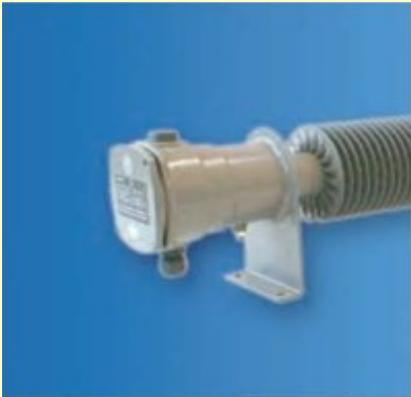
Abstand der Rippen zu seitlichen und oberhalb des Heizkörpers liegenden Gehäuseteilen / Wänden darf 100 mm nicht unterschreiten.
